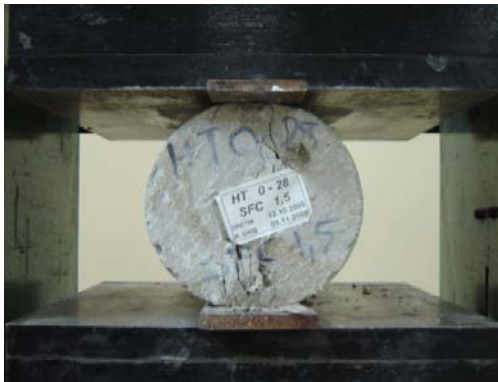
Şekil 3.11. Yarma Deneyi-Deney Sonrası Oluşan Çatlaklar
