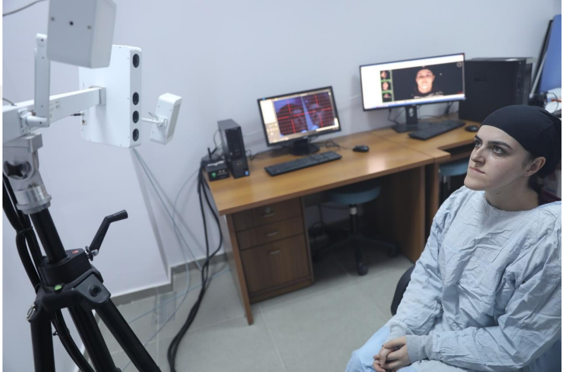
Şekil 3.2. 3dMD Face Sistemi ile 3 boyutlu fotoğrafların alınması
