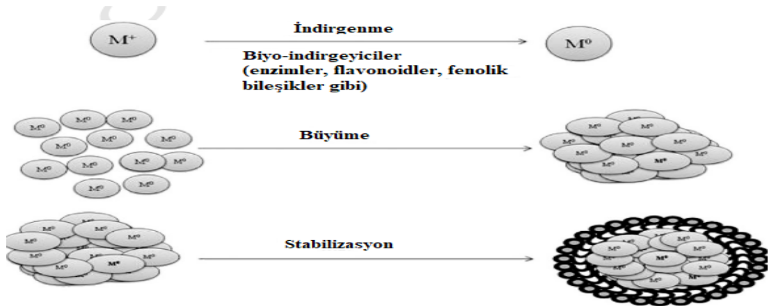
Şekil 1. 2. Metal nanopartikül sentezinin mekanizması
