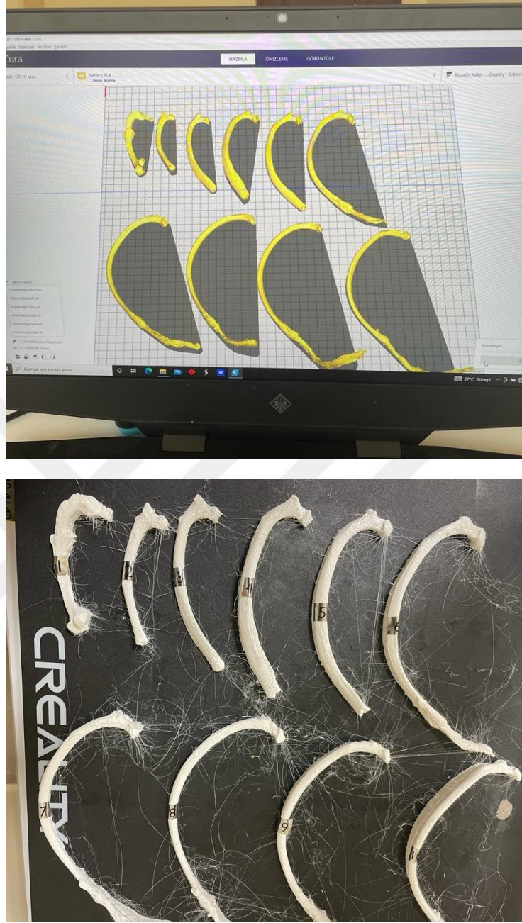
Şekil 3.9. Costae modelleme ve yazdırma.
