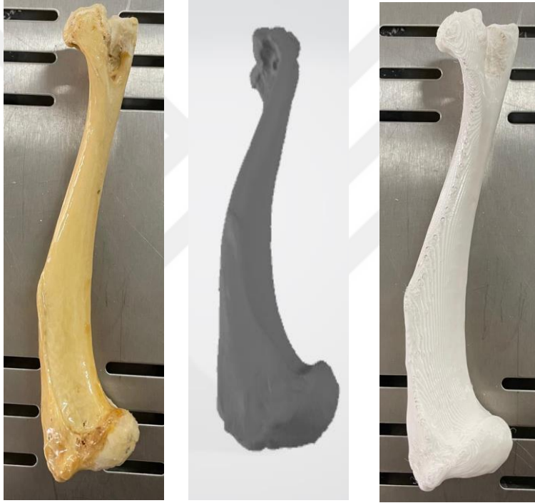
Şekil 3.5. Humerus iskeleti, dijital görünüm ve 3D yazıcı modeli.
