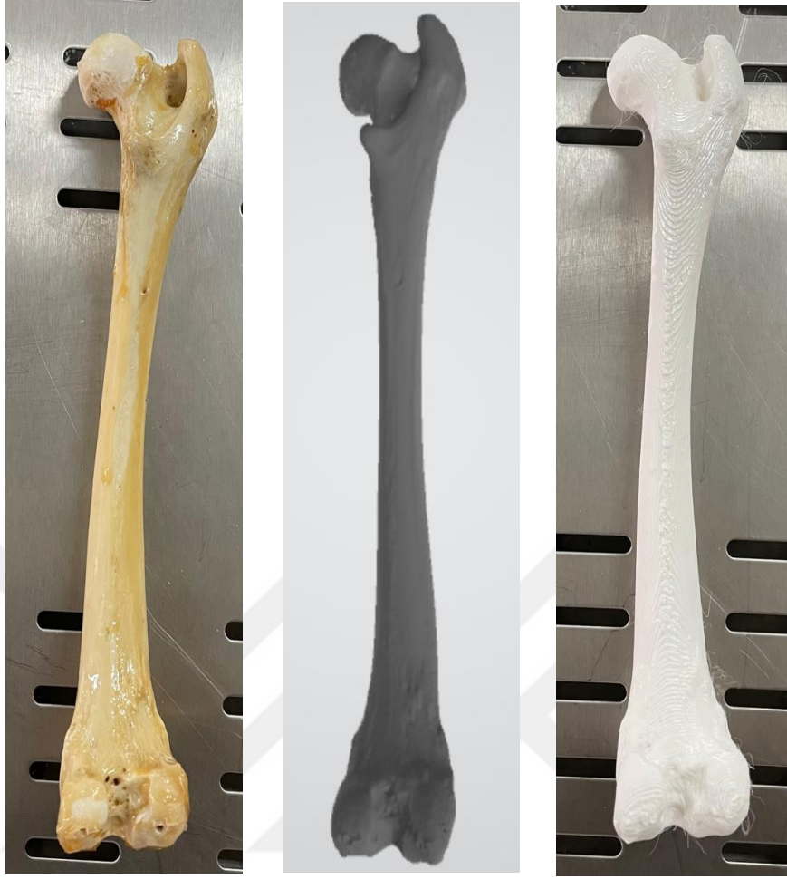
Şekil 3.6. Femur iskeletii dijital görünüm ve 3D yazıcı modeli.
