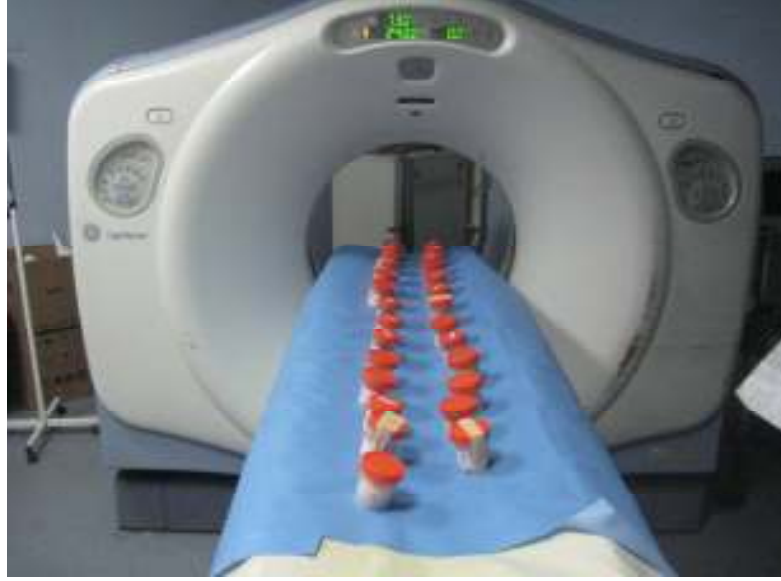
Şekil 5. GE Tomografi cihazı ile örneklerde ölçüm
