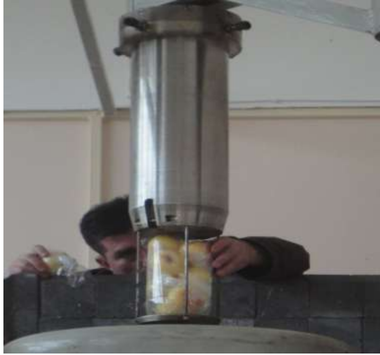
Şekil 2.9. P. expansum ile inokule edilmiş elmaların ışınlanması.
