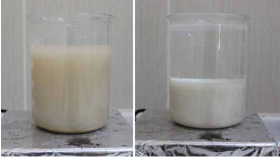
Şekil 7. Saf su içerisinde; a) hidrofilik, b) organofilik kilin görüntüleri.
