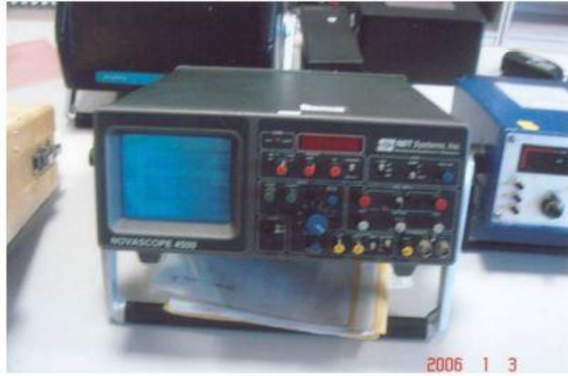
Şekil 2.6. Girdap akımları muayene yöntemi test cihazı [17]
