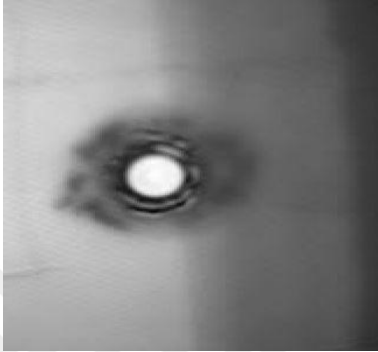
Şekil 6.6. İstikamet dümeninin sağ yüzünde bulunan, 2 numaralı askı noktasının etrafındaki suyun termal kamera ile görüntülenmesi
