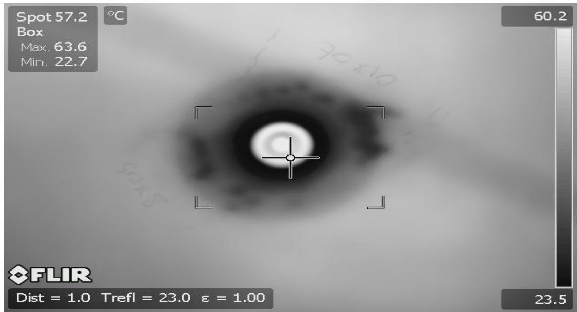
Şekil 3.11. Airbus A320 uçağının istikamet dümeninde yapılan bir termografik muayene sonucunda tespit edilen suyun görüntüsü
