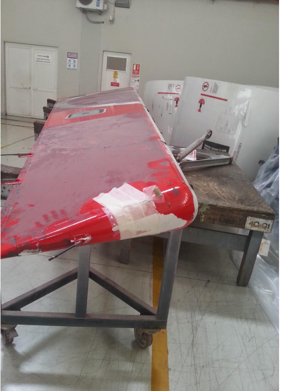
Şekil 6.8. İstikamet dümeninin tamir işlemi için uçak üzerinden sökülüp yatay olarak konumlandırılması
