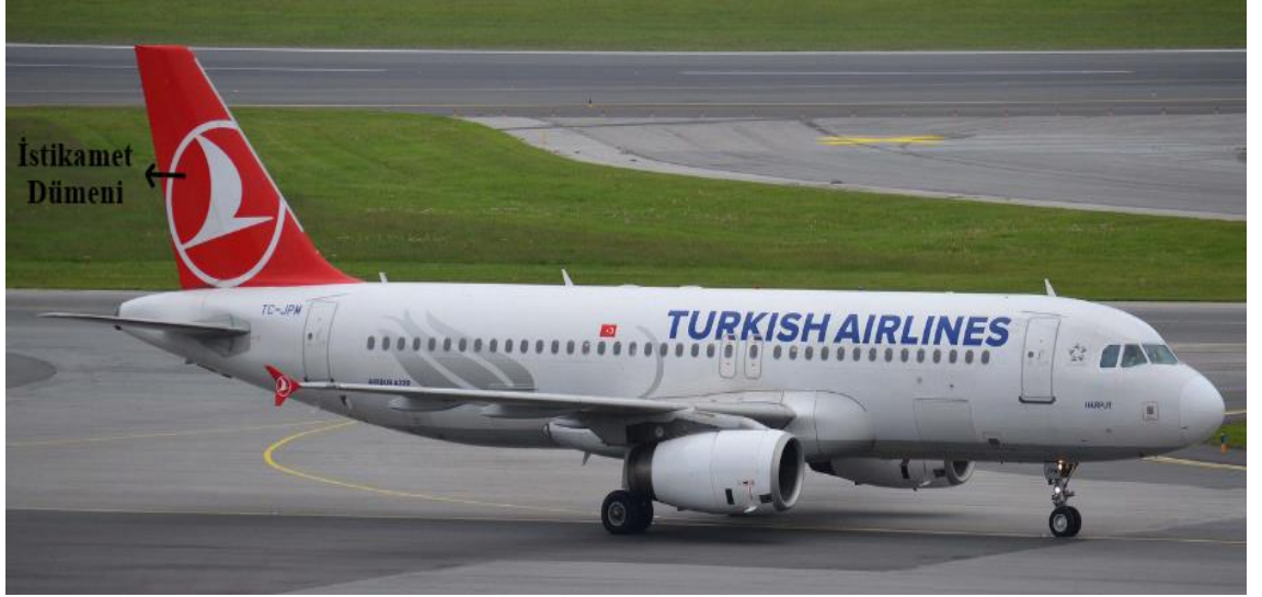
Şekil 5.1. Termografik inceleme yapılan uçağın istikamet dümeni
