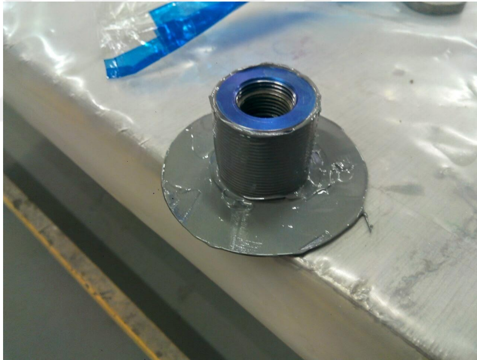
Şekil 6.13. Takım işlemi için hazırlanmış olan bush (yatak)
