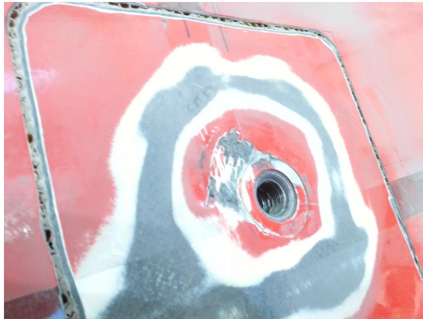
Şekil 6.10. Tamir yapılacak bölge kare biçiminde çerçeve içine alındı
