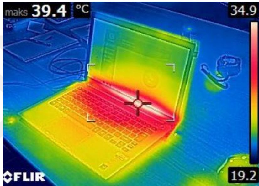
Şekil 3.1. Bir dizüstü bilgisayarın çalışma esnasındaki termal görüntüsü [25]
