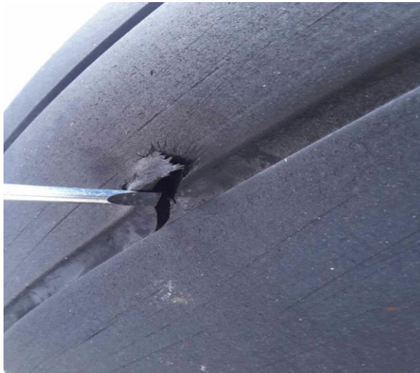
Şekil 2.1. Uçak lastiğinin oluşunda meydana gelen hasarın gözle muayenesi
