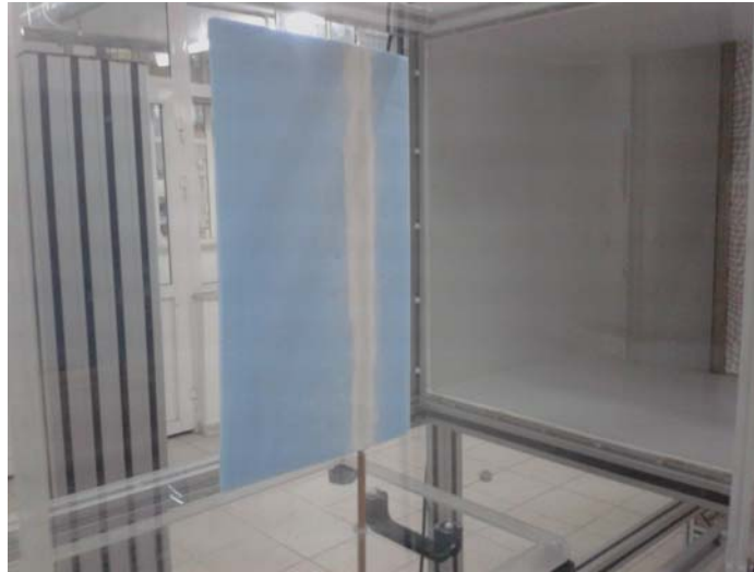
Şekil – 11 Kanat profilinin yüzey pürüzsüzlüğü giderildikten sonra rüzgar tüneline yük hücreesine sabitlenmesi
