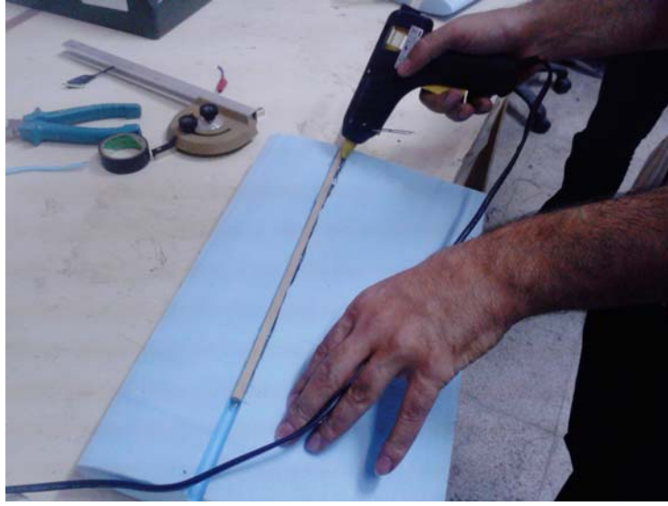
Şekil – 10 Kanat profilini yük hücreesine bağlamak için silindirik çubuğun kanada monte edilmesi
