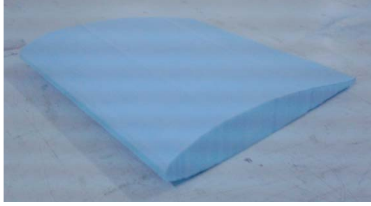
Şekil – 9 Profiller ile köpük malzemedan kanat üretimi
