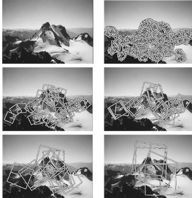
Şekil 5.6. 5 Piramit seviyesinde çıkartılmış çoklu-ölçekli yönelimli yamalar [120].
